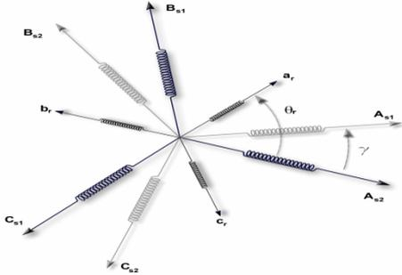
Figure 1. DSIM schema
