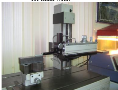
(d) TalySurf10 for surface roughness.
